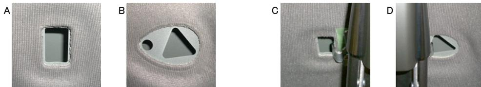
A: 左側のサンバイザー取付穴(取付フックが使用可能)
